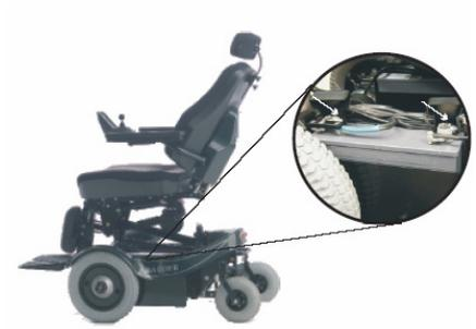
Entfernen Sie die Abdeckung, um Zugang zu den Batterien zu erhalten. Lösen Sie die Abdeckung, indem Sie den Dsuz gegen den Uhrzeigersinn drehen.
