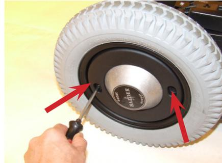
Lösen Sie die Radmuttern und wechseln Sie dann das Rad. Zur Befestigung des Rades gehen Sie in umgekehrter Reihenfolge vor.
